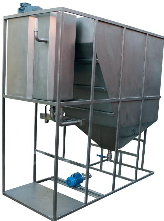
Крупные и мелкие примеси осаждаются на наклонную поверхность тонкослойного блока, после чего сползают в конусную часть, предназначенную для накопления отделенного и осевшего осадка, откуда удаляется в ручном или автоматическом режиме. Осветленная вода собирается с верхней части отстойника через специальную регулируемую переливную перегородку в карман для очищенной воды, откуда затем отводится в самотечном режиме.
